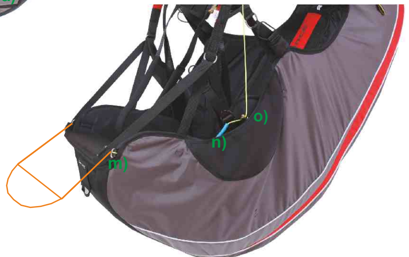
1) Schematische Darstellung Einbau Beschleuniger (Bauteile teilweise innenliegend verdeckt)
