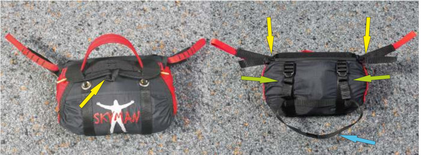
8. Obere Verschlussklappe schließen und mit den Splinten des Auslösegriffes sichern. Griff unter die Griffabdeckung stecken und Packschnüre entfernen.
