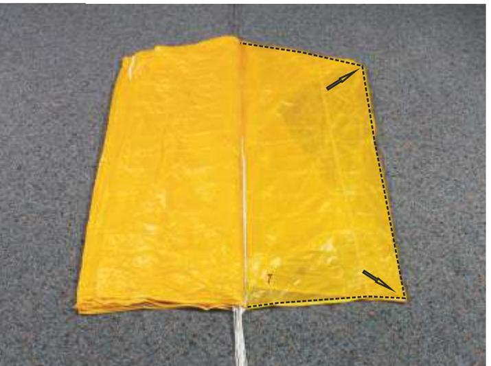
3. Bahn 9 (Ultra Cross 100/125) mittig zum Boden legen und die Bahn 8 zur Seite rausziehen.
