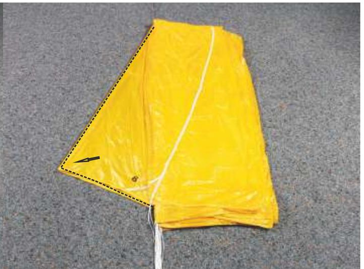
12. Bahn 9 (Ultra Cross 100/125) mittig zum Boden legen und die Bahn 8 zur Seite rausziehen.
