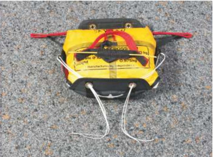
4. Je eine Packschnur rechts und links in die Schlaufen einfädeln.
