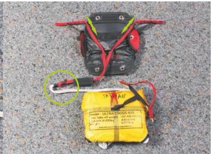
2. V-Leine in der gewünschten Position mit Hilfe des Klettbandes am Frontcontainer fixieren. Verbindungsleine des Rettungsschirms mit der V-Leine des Frontcontainers verbinden (Details siehe unter 3.)
