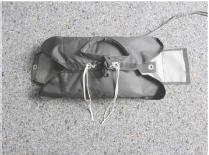
2. Mit Hilfe zweier Packschnüre die beiden seitlichen Verschlussklappen schließen und mit den Splinten des Auslösegriffes provisorisch sichern.
