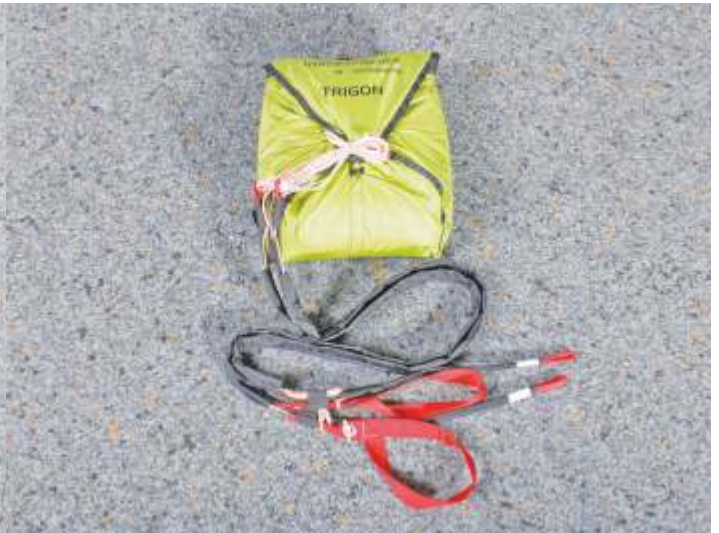
32. letzten Containerlappen mit Fangleinen verschließen.
