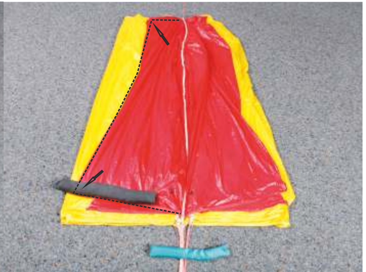
14. Bahn 1 legen (diese Bahn ist kürzer!) und mit Packgewicht beschweren.
