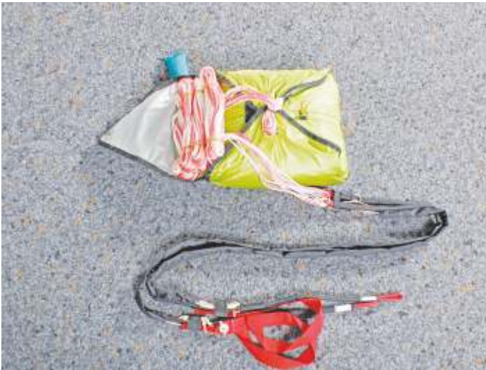
31. Fangleinenbündel auf den Container legen.
