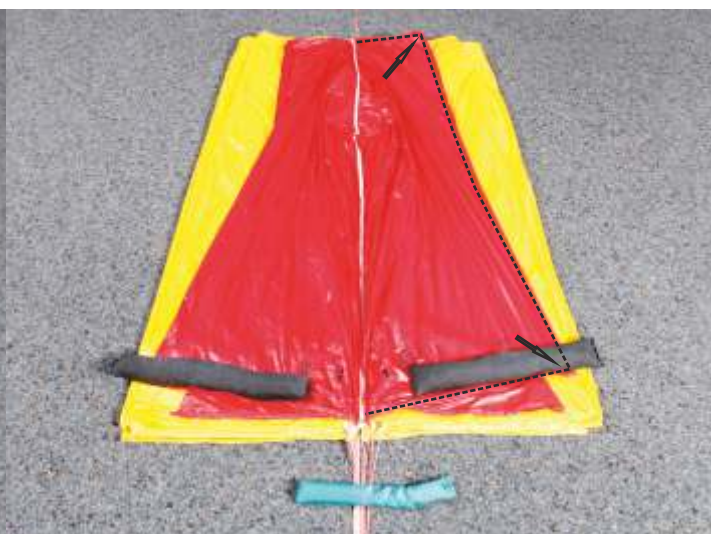
24. Bahn 1 legen(diese Bahn ist kürzer!) und mit Packgewicht beschweren.
