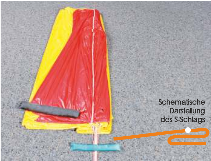
25. Rechte Seite S-förmig einschlagen (Schritt 1).
