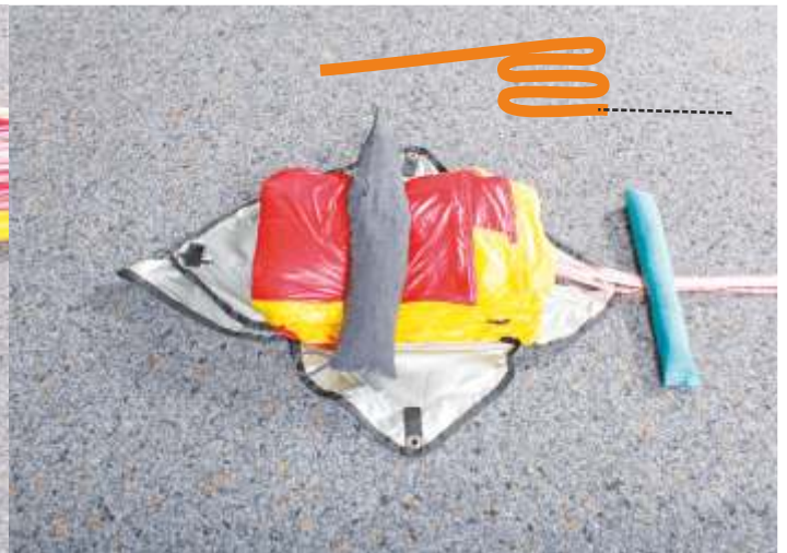
28. Restliche Kappe in S-Schlägen in den Container legen.
