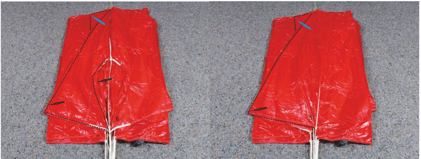
11. Bahn 6 legen (Eckbahn). Oberer Kappenteil herausziehen (blauer Pfeil)
