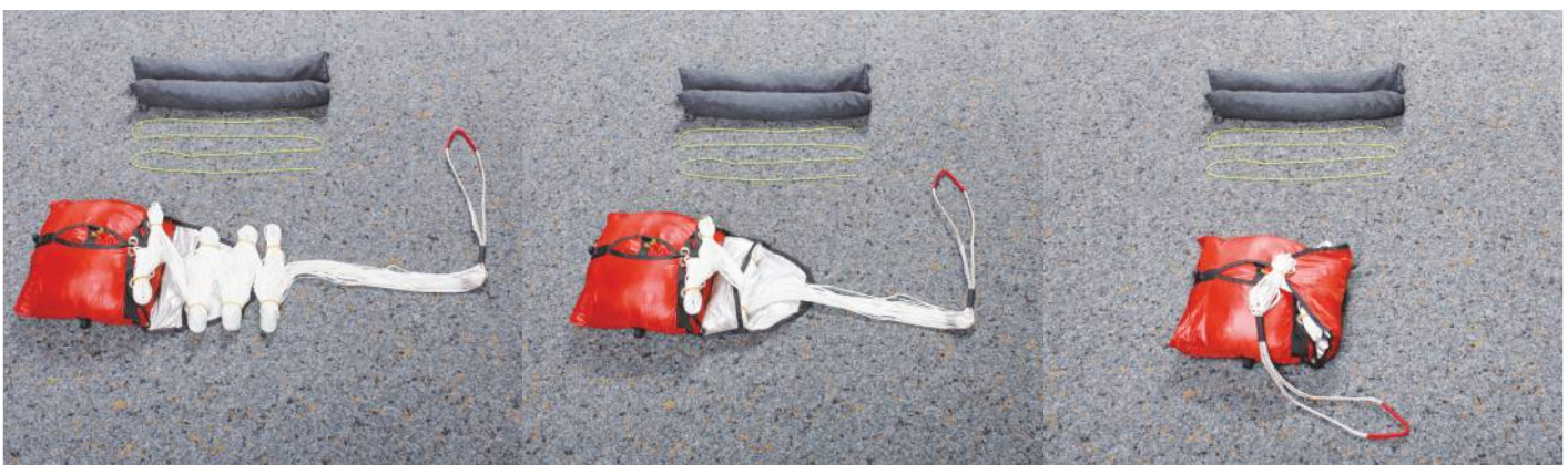
19. Container verschließen. Zuerst die Mitte, dann Außen. Fangleinen in 3 x 3 Achterschlägen bündeln. Die letzten 60 cm Fangleinen nicht bündeln.
