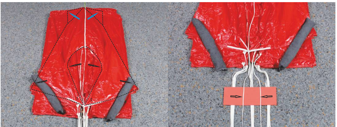
13. Bahn 1 legen. (Eckbahn) und Basis mit Gewicht beschweren. Oberer Kappenteil herausziehen (blauer Pfeil)
