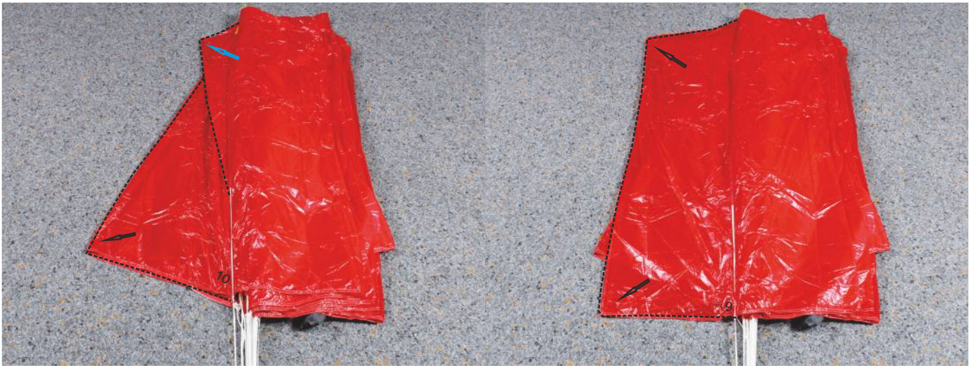
9. Bahn 11 mittig zum Boden legen, Bahn 10 zur Seite rausziehen, ebenso oberer Kappenteil (blauer Pfeil).
