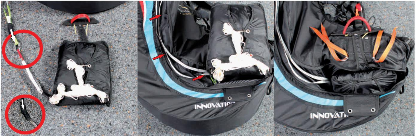
1. Verbindungsleine des Rettungsschirms mit der Verbindungsleine des Gurtzeuges einschlaufen oder mit einem Schraubglied (Festigkeit >2.400 daN) verbinden und Einschlaufung (z.B. mit Neoprenschlauch) gegen verrutschen sichern.
