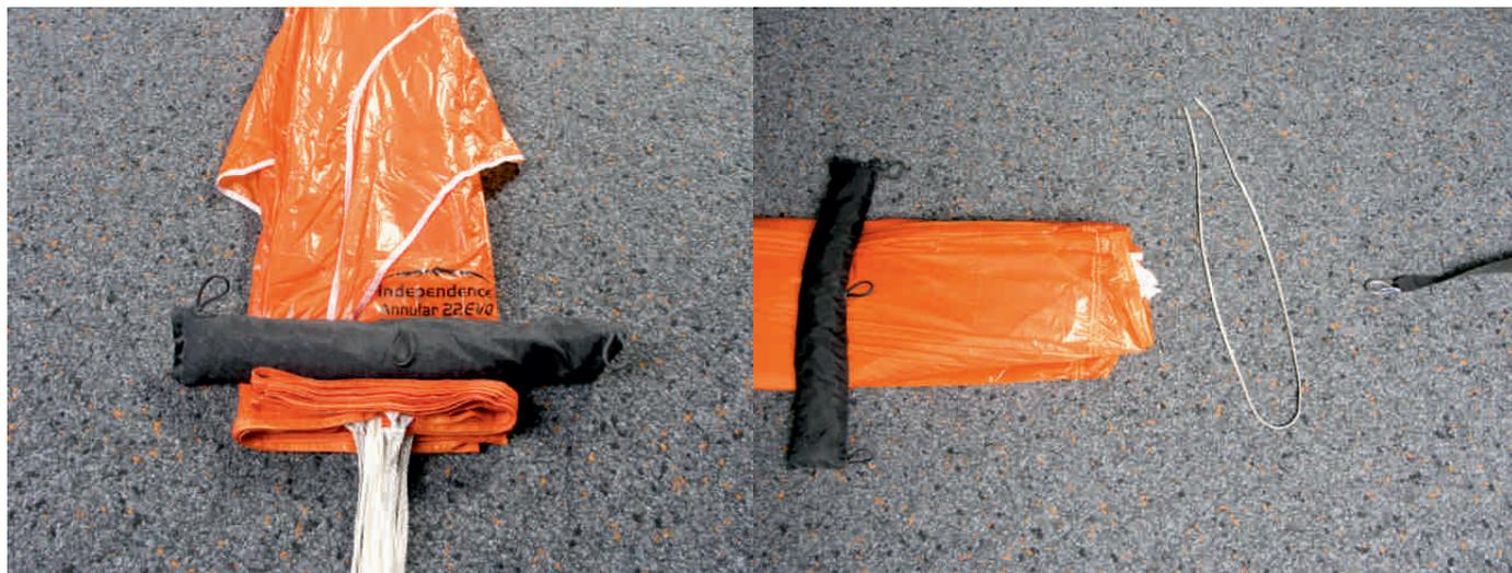
1. Basis S-förmig auf Containerbreite einschlagen (ggf.vorhandene RAM Air Pockets seitlich etwas herausziehen).
