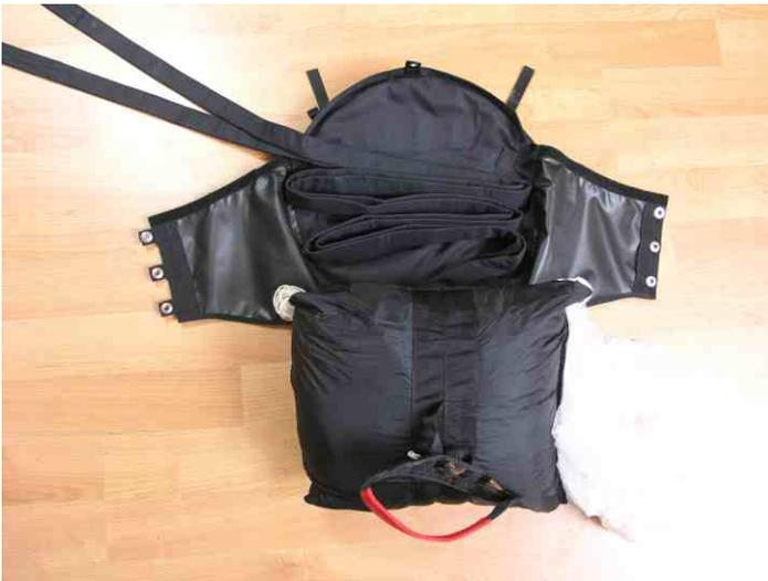
1. Verbindungsleine an der gewünschten Seite aus dem Außencontainer herauslaufen lassen.
