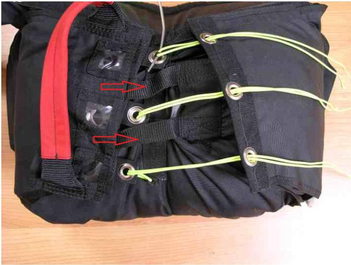
5. Die gegenüberliegende Verschlussklappe verschließen. Die beiden Verbindungsbänder vom Griff zum Innencontainer müssen zwischen den Verschlussösen vorbeigeführt werden (siehe rote Pfeile).
