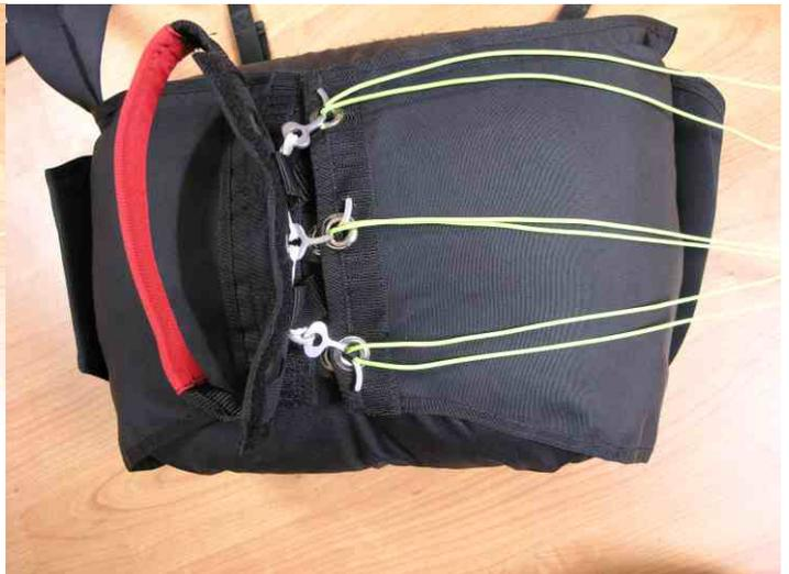
6. Verschlussklappe mit den Auslösesplinten sichern und die Packschnüre entfernen!
