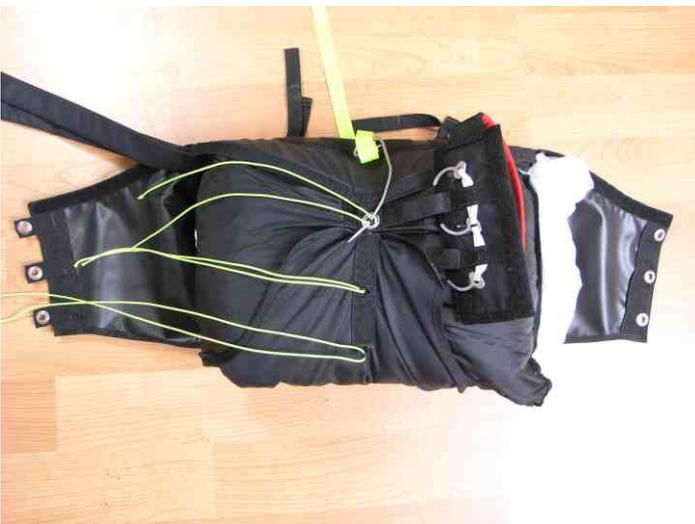
3. Drei Packschnüre einschlaufen, den oberen Deckel schließen und provisorisch sichern. Der Auslösegriff wird seitlich platziert.
